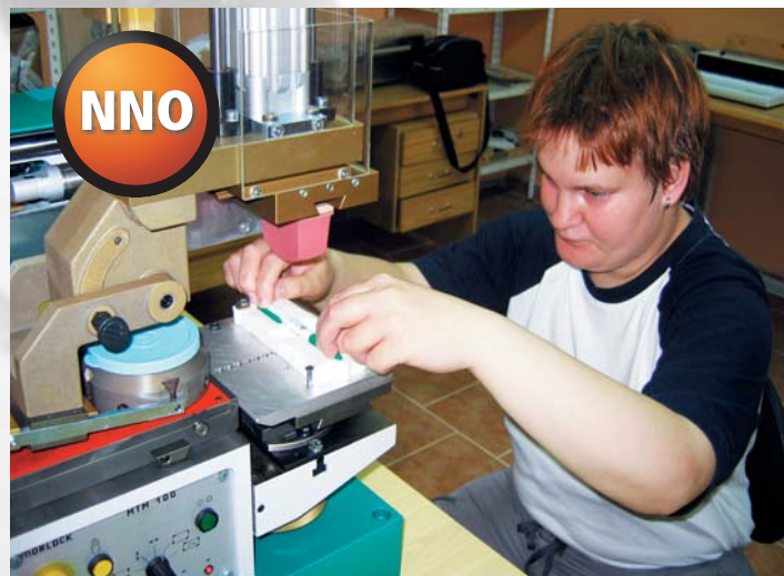
Účastnice kvalifikačního programu si zkouší potisk reklamních propisek na tampónovém stroji.
